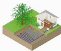
Pompe à chaleur sur capteurs enterrés horizontaux
