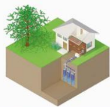
Pompe à chaleur sur corbeilles géothermiques
